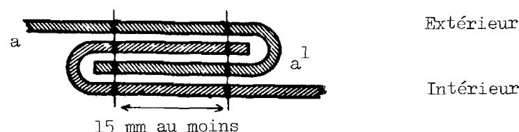
\*/ Les fils visibles de l'intérieur devront être de couleur différente de celle des fils visibles de l'extérieur et de celle de la bâche.
